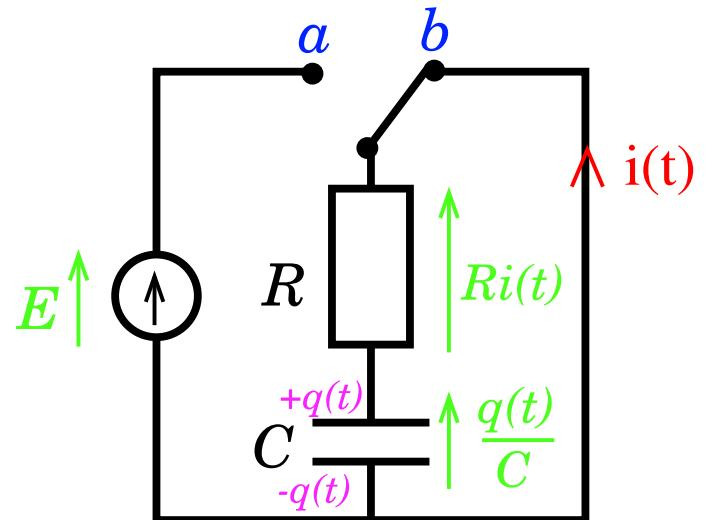
$$\text{L'intensité s'obtient avec } i(t) = \frac{dq}{dt} \text{ soit : } i(t) = -\frac{E}{R} e^{-\frac{t}{RC}}$$
