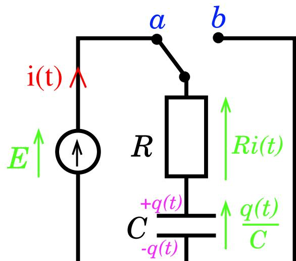
L'intensité s'obtient avec  $i(t) = \frac{dq}{dt}$  soit :  $i(t) = \frac{E}{R} e^{-\frac{t}{RC}}$
