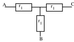
avec  $r_1 = \frac{R_1}{3}$  D'où le circuit :
