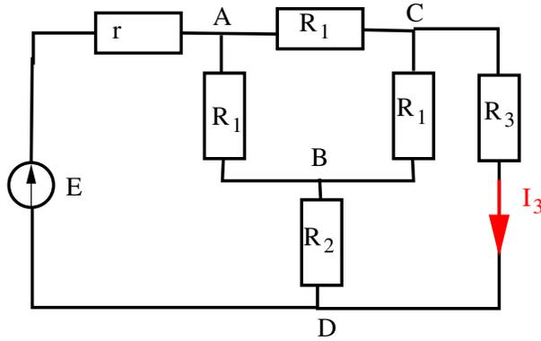
On remplace le triangle (ACB) par un schéma étoile :
