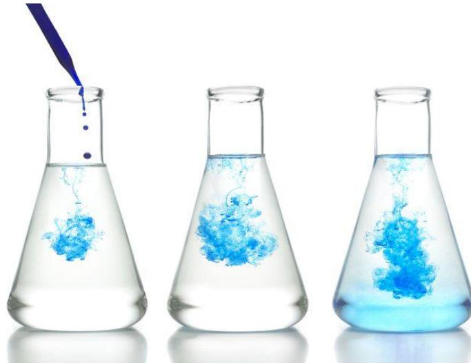
Le phénomène de **diffusion** d'une espèce (ici l'encre dans l'eau) est lié au mouvement individuel des « particules » (ici les molécules d'encre) composant l'espèce diffusant.
