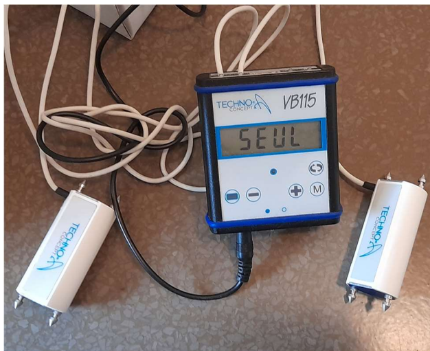
Figure 2 : les vibreurs seront placés au niveau des tendons d'Achille (un vibreur par tendon) et tenus par un membre du groupe pendant toute la durée de l'acquisition (51,2 secondes). Ils sont à manipuler avec précaution car ils sont fragiles.
