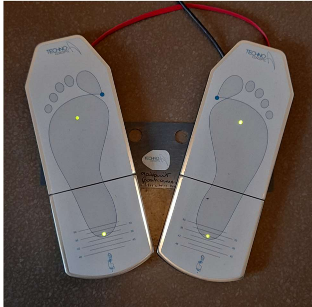
Figure 1 : plateforme d'équilibration. Les 3 capteurs situés sur chaque plateforme vont permettre de connaître la projection du centre de masse du sujet qui sera positionné sur ces plateformes.
