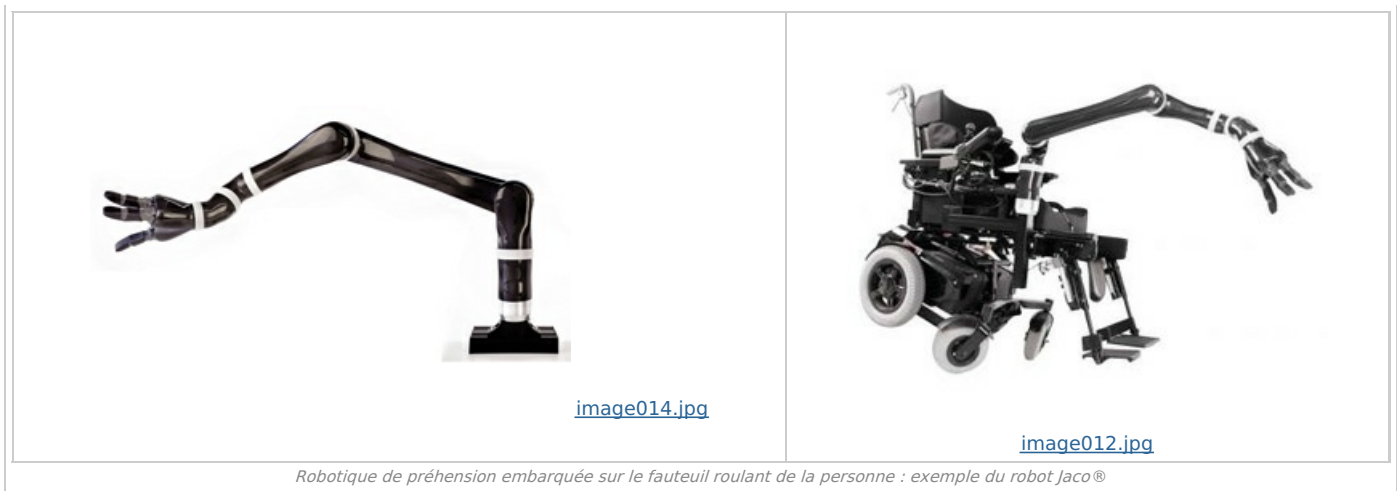
Robotique de préhension embarquée sur le fauteuil roulant de la personne : exemple du robot Jaco®
