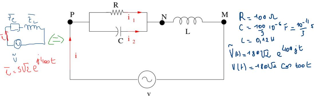
On applique entre les points P et M une différence de potentiel sinusoïdale  $v$  de pulsation  $\omega = 400 \text{ rad.s}^{-1}$  et de valeur efficace  $180 V$ .
