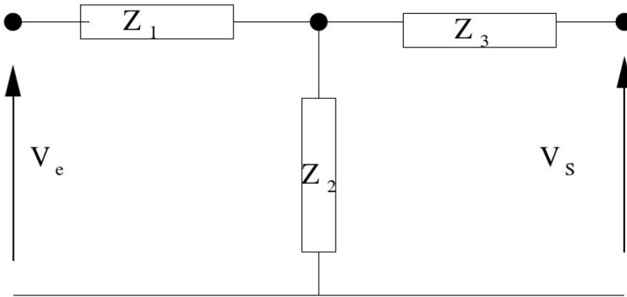
2. L'impédance  $Z_1$  est réalisée par la mise en parallèle d'un condensateur de capacité  $C$  et d'une self idéale  $L$ ;  $Z_2$  est une résistance  $R$ . On posera  $K(\omega) = \frac{L\omega}{1-LC\omega^2}$ .
