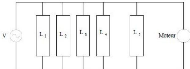
1. Calculer les valeurs efficaces des courants circulant dans les lampes et le moteur, ainsi que la valeur efficace du courant total. Donner une représentation des grandeurs complexes associées. Calculer le facteur de puissance  $\cos \Phi$  du circuit.
