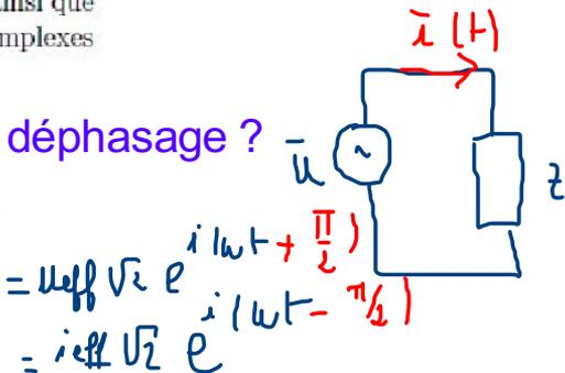
$\Rightarrow$  circuit partiellement inductif de phase  $\phi$
