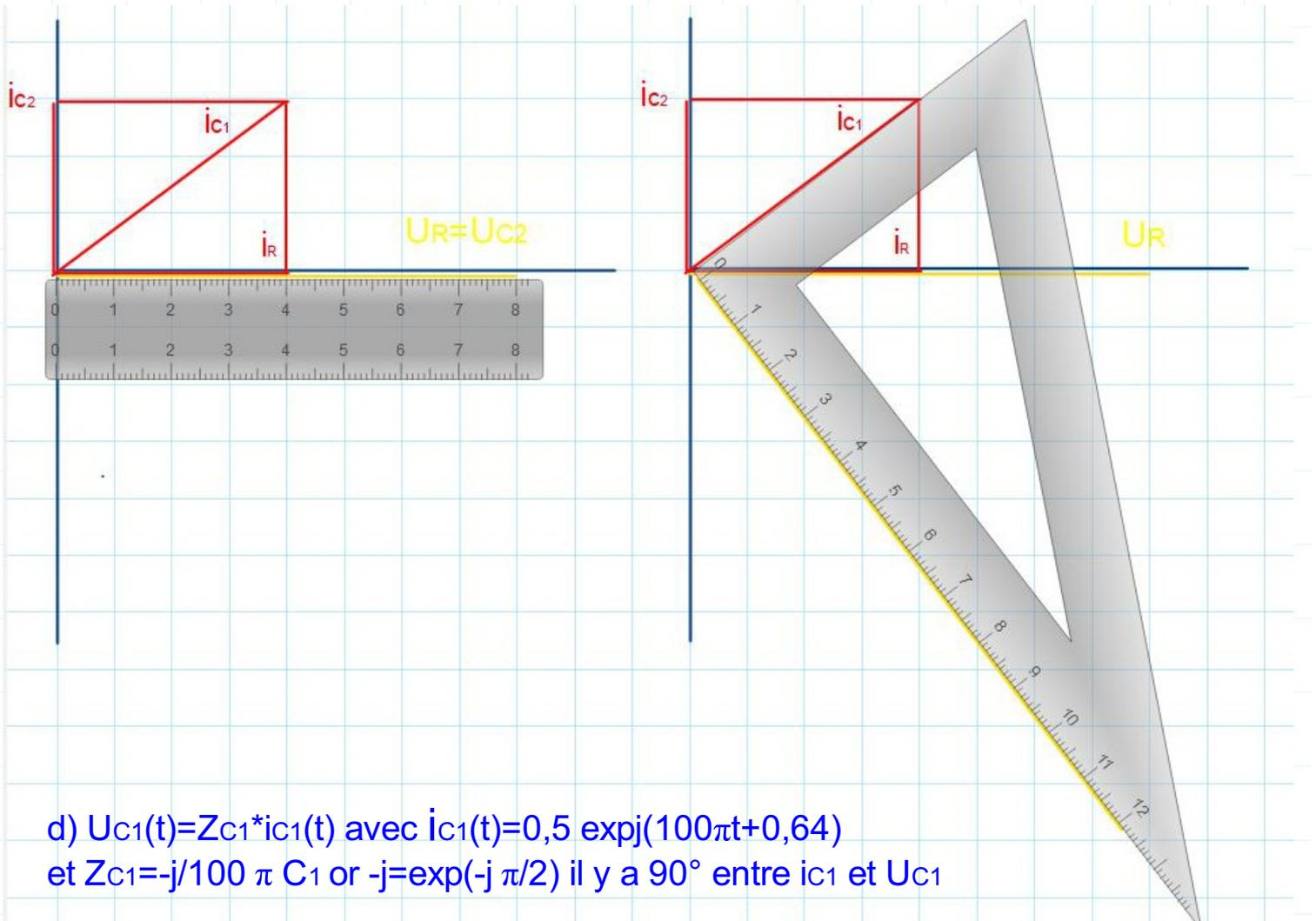
d)  $U_{C_1}(t) = Z_{C_1} \cdot i_{C_1}(t)$  avec  $i_{C_1}(t) = 0,5 \exp(j(100\pi t + 0,64))$
