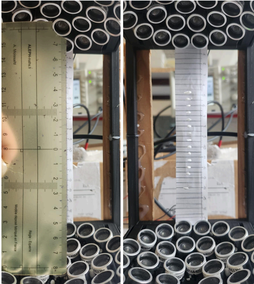
Figure 2 : Tableau récapitulatif de la position des billes de polystyrène sur l'échelle de la règle en papier au fond du dispositif et sur l'échelle de la règle
