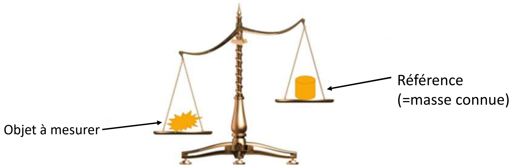
Figure 1 : Représentation schématique de la balance de Roberval
