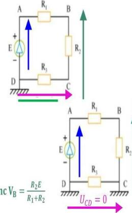
figure 4 : Le point B est mis à la masse à la place du point C  $V_D = V_B = 0$
