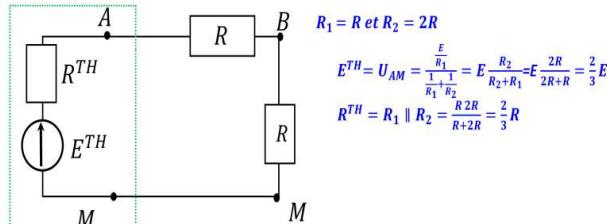
3. Appliquer le théorème de Millmann sur le schéma équivalent du schéma 2 trouvé à la question 2 pour déterminer  $U_{BM}$ .
