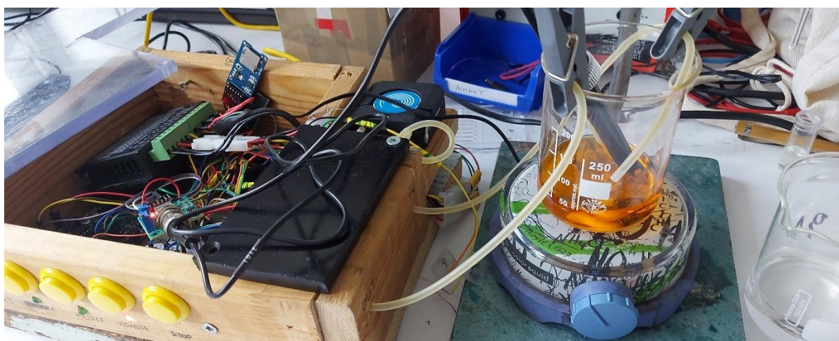
Figure 5 : Montage avec agitateur magnétique, pompe péristaltique (boîtier noir avec disque bleu) et système LED, cuve et photodiode sous le capot noir
