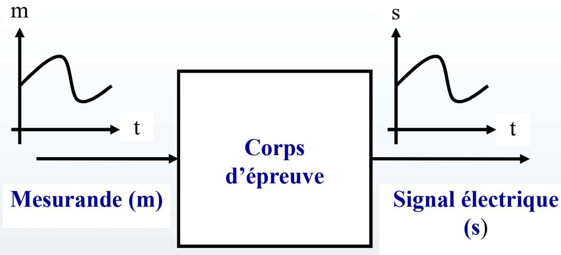
Le **transducteur** (corps d'épreuve) est sensible au **mesurande**, sous l'effet duquel il fournit un **signal** :  $s = f(m)$
