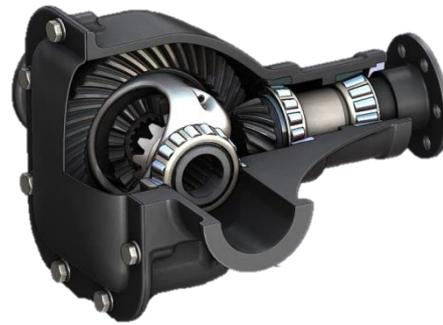
Figure N°1 : Différentiel automobile
